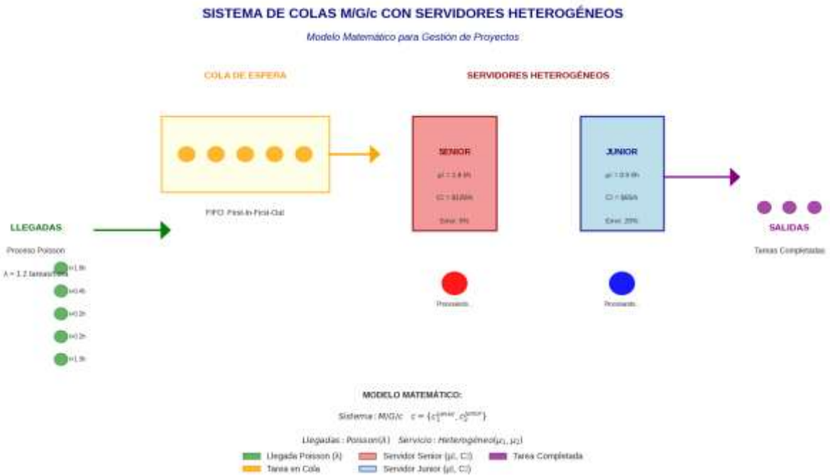
Figura 3. Representación esquemática del sistema de colas con servidores heterogéneos.
